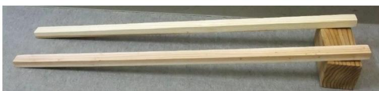
図 1-1 著者が試した道の土台(9cmの角材の上に100cmの板2枚を置く)
