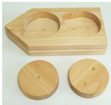
図2-2-3 穴を開けた板を重ねた船の土台
