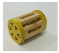
全てヒノキ板を使用した。飾り穴を開けた直径 7cm の厚さ 1.2cm の板を長さ 7cm 幅 3cm 厚さ 9mm の飾り穴を開けた板 4 枚で繋ぎ、中に厚さ 2cm の木片 4 個を入れた。丸板を黄色の水性ステインで着色した後、ウレタンニスを塗って仕上げた。木工用ボンドで接着した後、ねじの頭が表に出ないよう、壷錐で窪みをつくった上で、長さ 1.5cm の木ねじで固定した。転がすとカラカラと音のする玩具となった。
