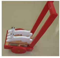
キ木枠に直径 14cm のキリ板車輪をつけ、車軸につけた棒が、ウサギの形に切ったキリ板を固定した角材を押し上げるようにして動く車を製作した。押すための持ち手の高さは 49cm である。2 輪なので、木枠の後方を浮かせるように操作しないと後ろを引きずってししまった。後方に小さな車輪をつけるとよい。ウサギを白、枠、車輪、持ち手を赤の合成樹脂塗料で塗装した。押すとウサギが跳ねるように動き、カタカタと音がする。
