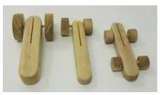
直径5mmの丸棒以外は厚さ3.2cmのクス材で製作した。大きい方の持ち手は幅3.2cm長さ14.5cm厚さ2.5cmで上下を半円とし、中心を長さの半分まで幅2mmの溝を開け、側面端から4分の1の長さの所に、5.5mmの穴を開けた。2枚の丸板は直径5cm厚さ1.6cmで中央に5mmの穴を開け直径5mm長さ10cmの丸棒で繋いだ。小さい方は、幅2.5cm長さ14.5cm厚さ1,6cmで同様に溝と穴を開けた。2枚の丸板は直径3.5cmで中央に同様の穴を開け大きい方と同じ長さの丸棒で繋いだ。人型のような形となり、大きい方は低く大きな音、小さい方は高く小さな音がする。(写真左)また、丸棒の長さを大きい方を7.5cm、小さい方を6.5cmにし、丸板をアクリル塗料で着色したものを製作した。音と音の間隔が短くなった。(写真中)
