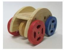
全てヒノキ材を使用した。直径 6cm 厚さ 1.2cm の板を、直径 1.5cm 長さ 7cm の丸棒に直径 2cm の穴を開けた直径 4.5cm の板を通して木工用ボンドで繋いだ。これも、木ねじの頭が出ないように窪みをつくった上で固定した。タイヤ状の板を青と赤にしたものを製作した。上下に振るとカタカタ音
